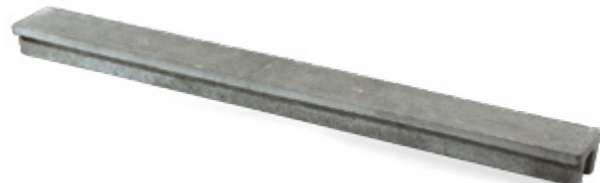
D3 Belka podwalinowa 220 (zbrojona) wys. 12 cm dł. 220 cm szer. 21,5 cm
